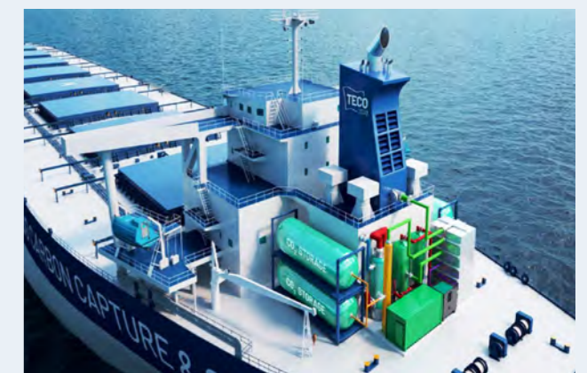
[ TECO 2040 ASA와 Chart Industry의 극저온 탄소포집 공정 기반 선박용 CCS 시스템 ]
